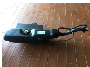
DEPOSITO GASOLEO MEGA 1º MODELO USADO
