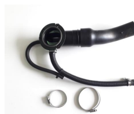
GARGALO DEPOSITO COMPLETO GRECAV EKE
